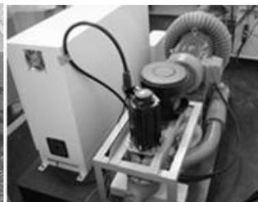
図2 実変動風圧載荷装置
