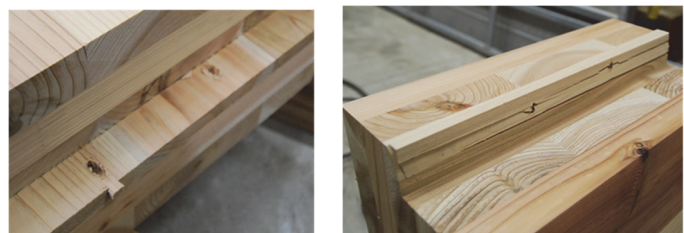
図 17 破壊性状 (左：強軸、右：弱軸)
