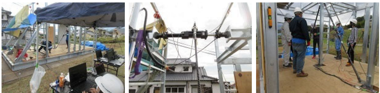
図8 実地盤上に建設した試験建屋と振動実験の様子
