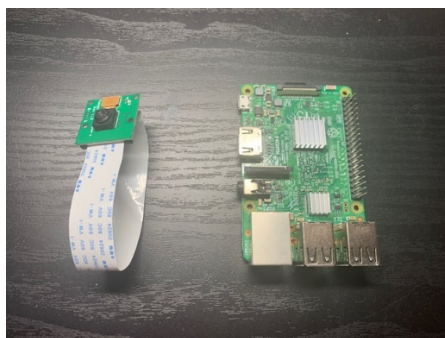
写真 2 使用した Raspberry PI (右) と PI Camera
