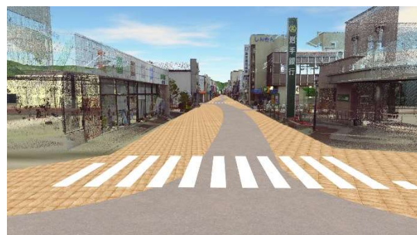
図3 宮古市市道末広線の3D計測と電柱削除およびCG歩道（左：計測データ、右：電柱除去）
