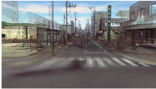
図3 宮古市市道末広線の3D計測と電柱削除およびCG歩道（左：計測データ、右：電柱除去）
