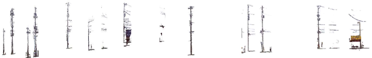
図8 自動抽出された電柱の点群データ
