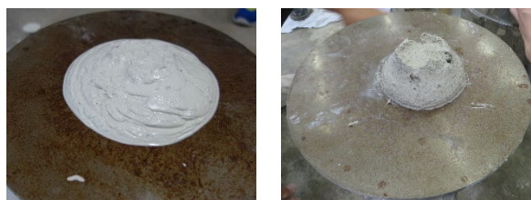
写真-1 フロー試験 (左: ペースト, 右: モルタル)
