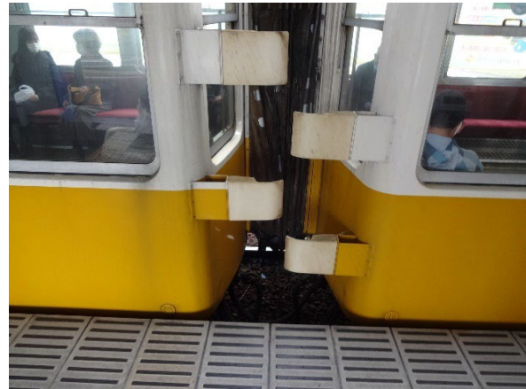
写真 6. 互い違いの転落防止幌は白杖で検知 しにくい (ことでん琴平線)
