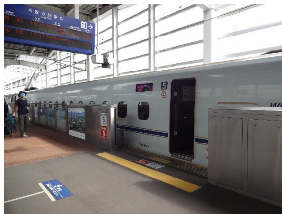
写真 33. 写真 32 と同じ路線であるが、ホームドアと車両の間隙はない（JR 鹿児島中央駅）
