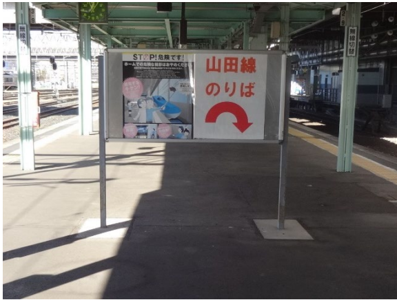
写真 21. 白杖で検知できない障害物 (JR 盛岡駅)
