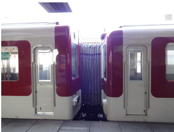
写真3. 大きな空間が空いた車両の連結部 (近鉄鳥羽線)
