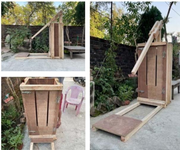
図 1：自作したストローベイル圧縮機
