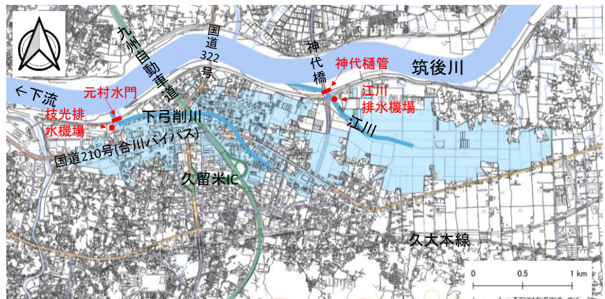
図 2 下弓削川・江川流域の浸水範囲(水色が浸水範囲)(福岡県河川整備課の資料を基に筆者らが作成)
