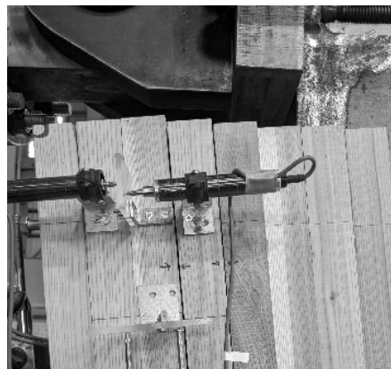
写真1 面内せん断試験の様子
