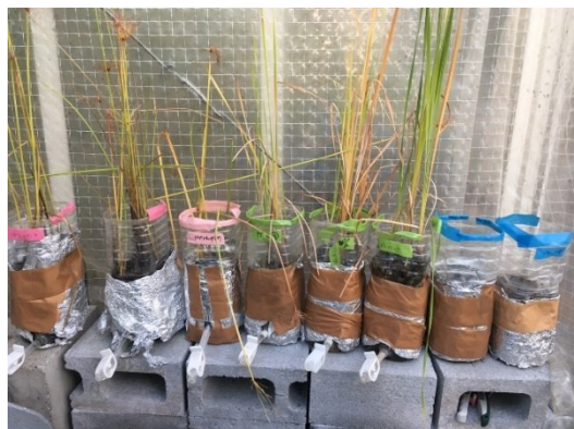
図2 ラボスケール人工湿地. 左からパピルス砂利系、ガンマ砂利系、砂利系（各2系）.
