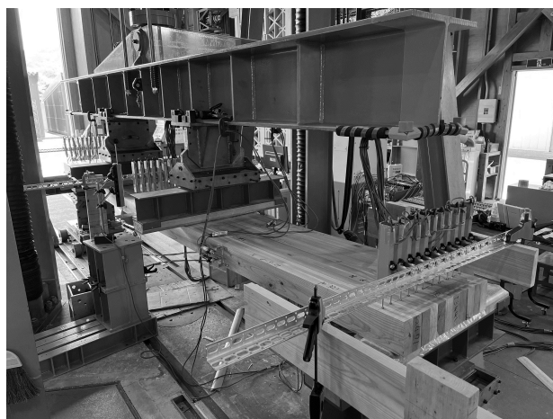
写真 1 NLT の曲げ試験の様子
