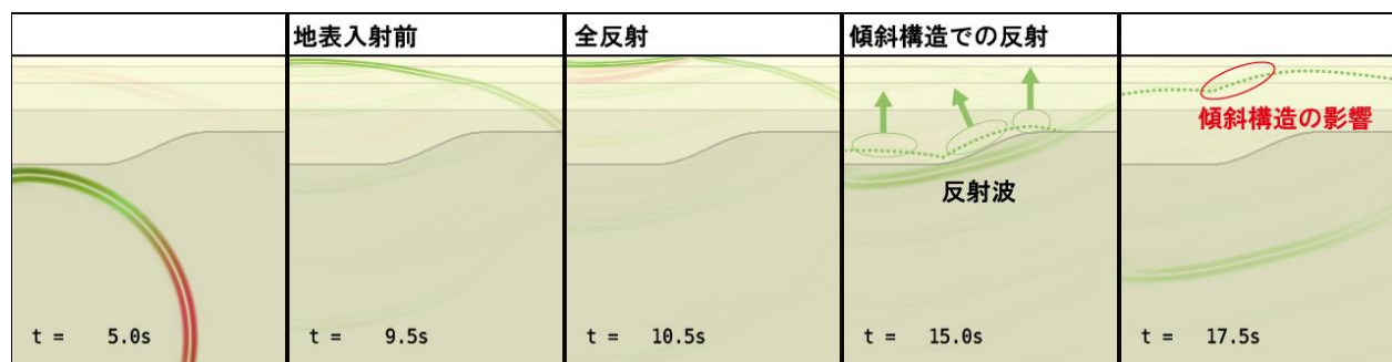
図 5 スナップショットの一例，緑が S 波，赤が P 波を示す．
