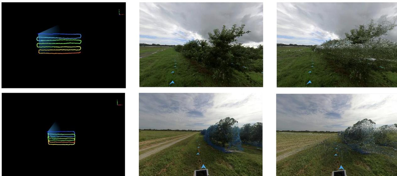
図5 再現結果（右：移動経路、中央：RGB画像、右：点群にRGBを重ねた画像）
