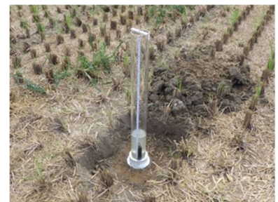
写真 2-2 原位置透水試験(地点 O)
