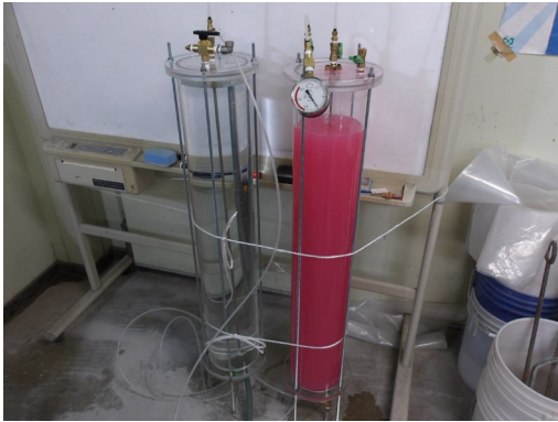
写真-1 透水試験装置(タンク部)
