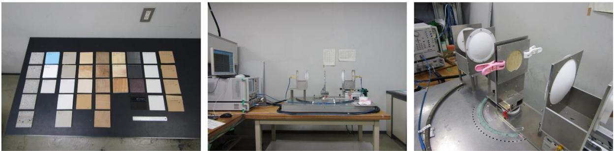
図 1. 自由空間法（ベクトル・ネットワーク分析器利用）による建材測定の様子
