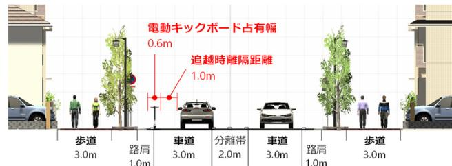
図 3 VR 実験で用いた道路の横断構成
